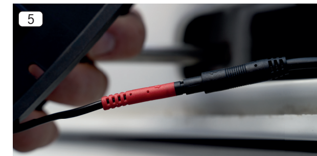
5. Connectez la sortie jack 3,5 mm du capteur de la caméra à la contrepartie verte du fil principal et enroulez-la autour d'un ruban isolant pour empêcher l'eau de pénétrer dans le connecteur.
