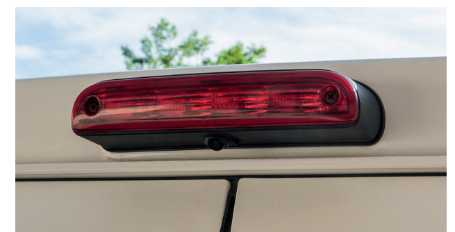
9. Ausrichten der Kamera-Kugel unten am Hauptgehäuse, mit dem beiliegenden U-förmigen Werkzeug, falls nötig.
