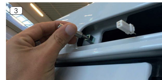
3. Die Montagebolzen aus Edelstahl einschrauben und unter Zugabe von etwas Loctite handfest anziehen (5Nm).
