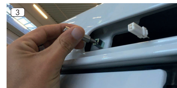
3. Vissez et serrez les entretoises en acier inoxydable à la main (5 Nm). Utilisez un peu de frein filet, si possible.
