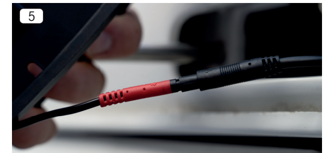
5. Verbinden Sie den 4PIN mini Stecker des Kabels vom Kamerasensor mit dem mini Stecker Gegenstück des Hauptkabels. Sichern Sie die Steckverbindung mit Isolierband.
